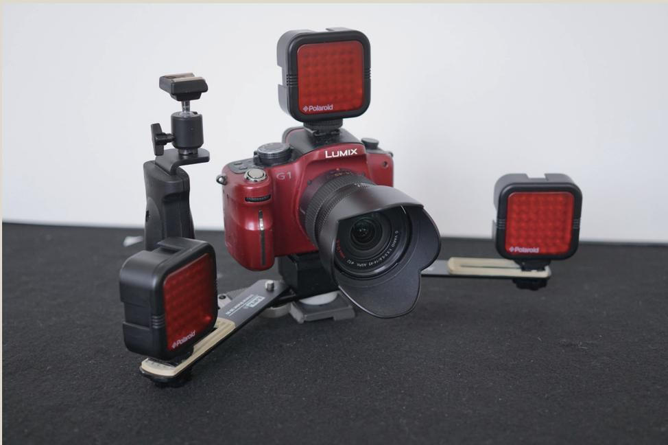
図4 実際に自作した近赤外線カメラ
